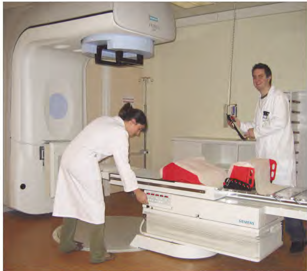
Appareils de dernière génération, les accélérateurs de particules du centre de radiothérapie sont équipés d'un "collimateur multilame", qui sculpte le rayonnement à la forme de la tumeur et protège ainsi les autres organes.
