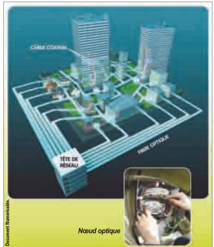
Seuls les câbles coaxiaux entre la tête de réseau et les immeubles vont être remplacés par la fibre optique. Situés en bas des immeubles, les nœuds optiques transforment le signal optique en signal numérique.
