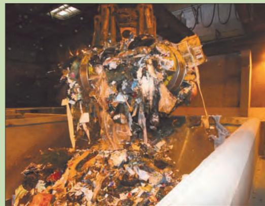
Le grappin hydraulique saisit à chaque prise 2,5 tonnes de déchets qu'il dépose dans les trémies de deux fours.
