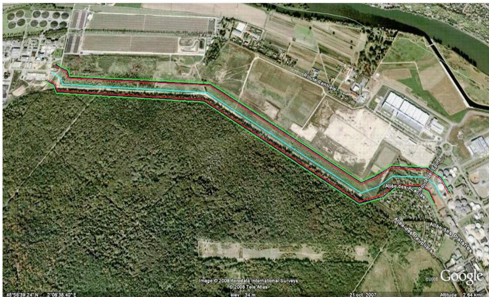
Scénario 1b : UVCE (Unconfined Vapour Cloud Explosion / Explosion de gaz à l'air libre) sur canalisation de biogaz
