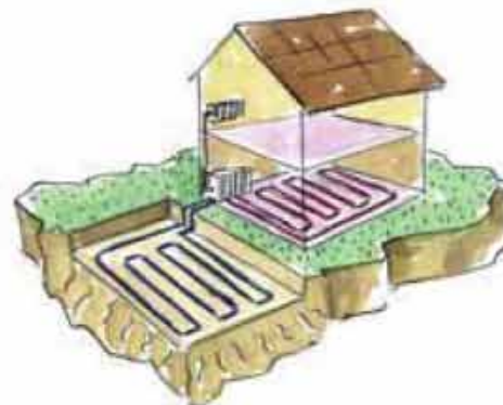
Capteurs horizontaux enterrés à environ un mètre
