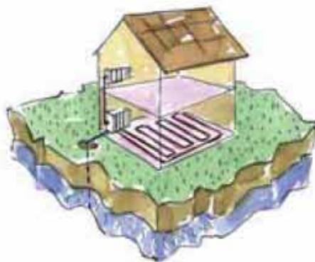
Captage par forage sur l'eau de la nappe phréatique
