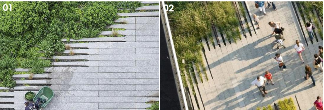
Des revêtements poreux et le recours à la végétation pour favoriser l'infiltration des eaux pluviales – source : Empreinte paysage
