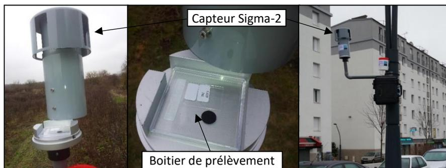
Figure 28 : Capteur Sigma-2 pour la mesure des PM10
