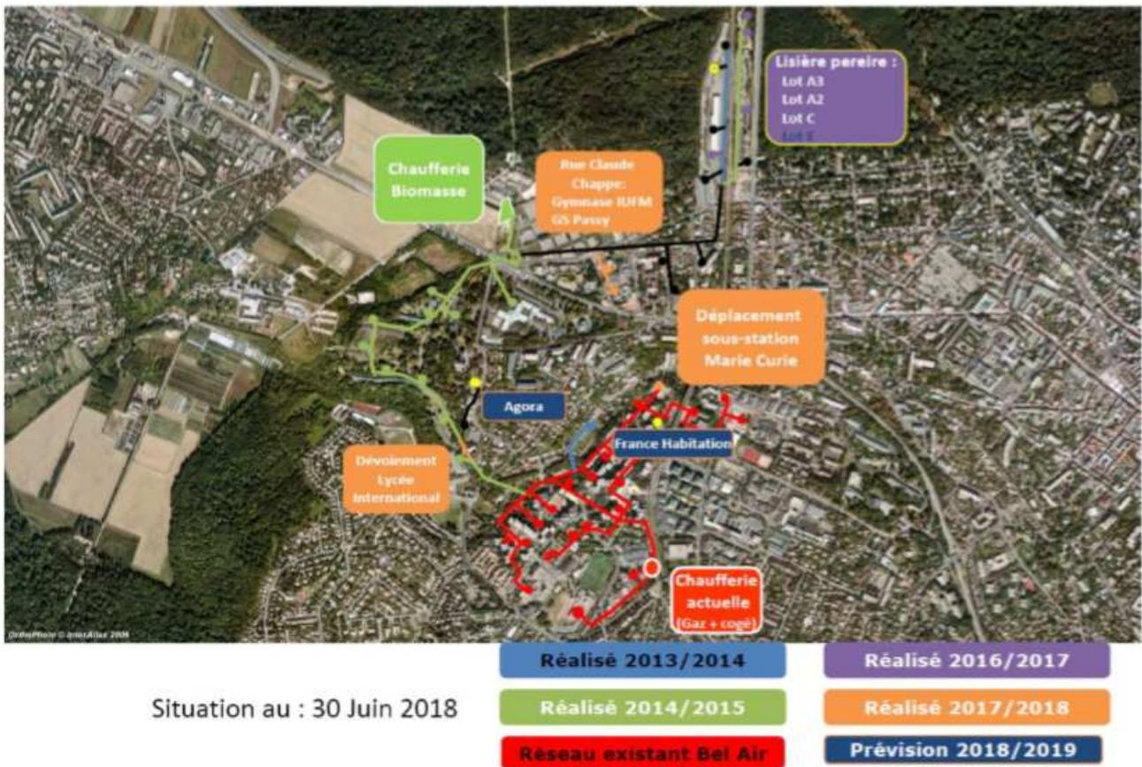
Figure 2: Plan des sous stations du réseau de Saint-Germain-En-Laye
